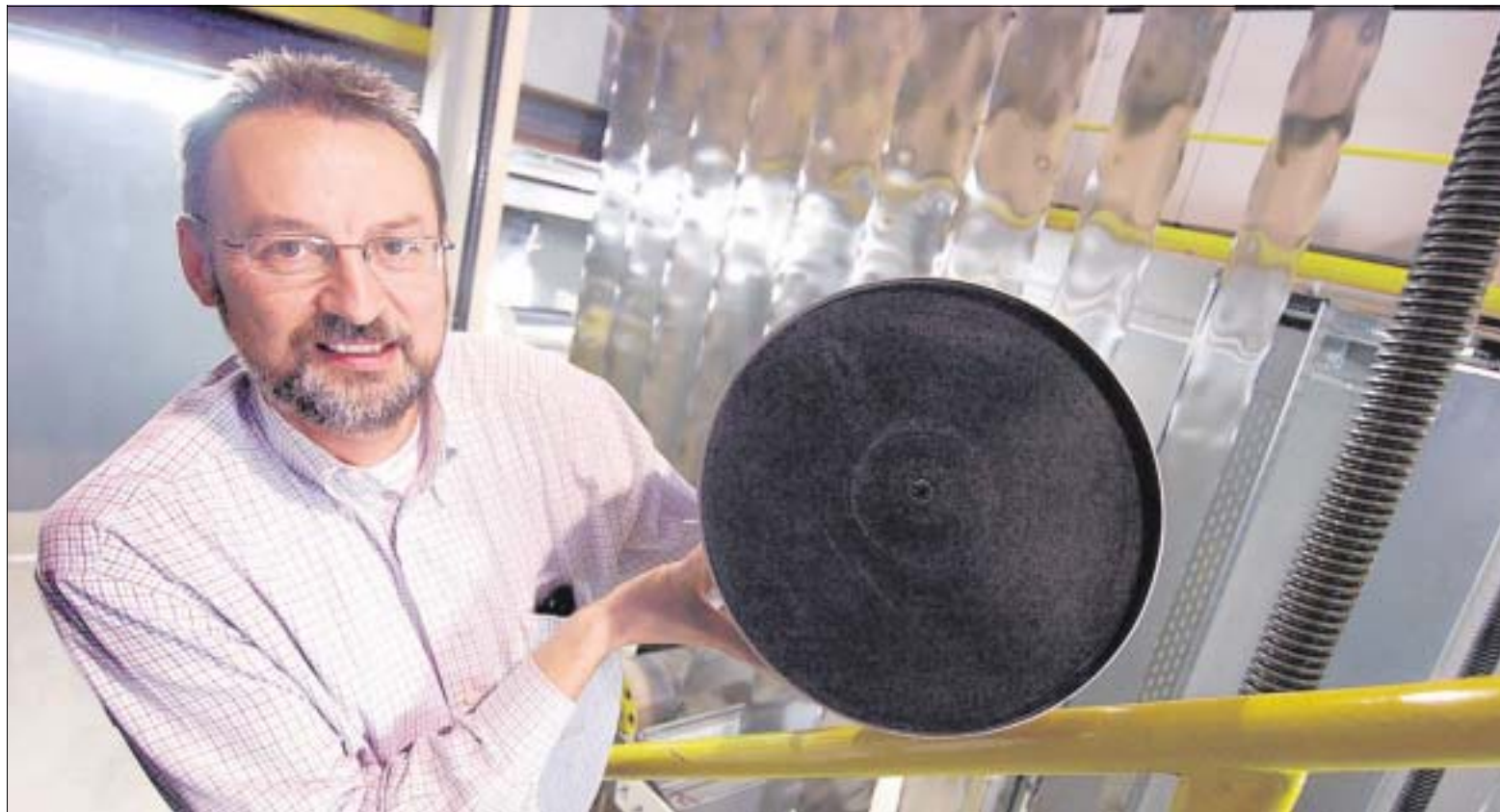
Das ist ein dickes Ding: MK-Geschäftsführer Gerd Cloppenburg mit einem Lkw-Katalysator, dessen Innenleben aus acht Kilo hauchdünnen MK-Folien zusammengefaltet ist. Im Hintergrund: Der neue Glühofen. (WR-Bild: Theo Schmettkamp)
