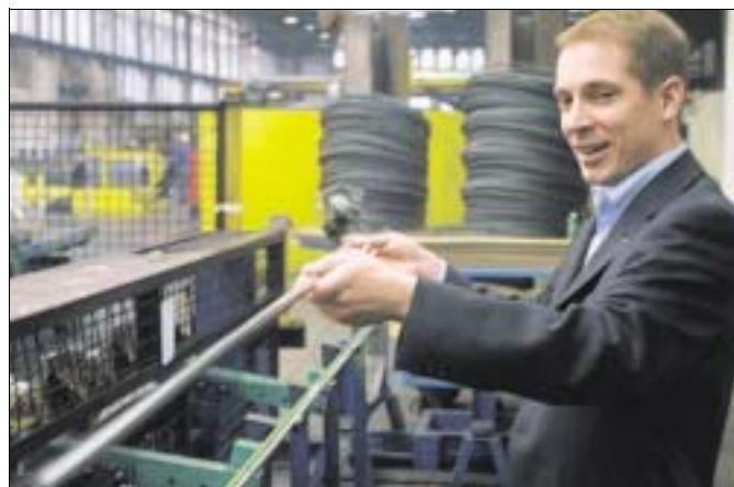
Betriebsingenieur Florian Kanzer: Aus diesen Stahlstäben werden die Federn gewickelt. (WR-Bilder: Anja Schröder)
